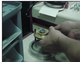
**Fig. 26 Placa introducida en el Recubridor Iónico.**
