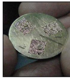
**Fig. 28 Placa con las muestras recubiertas en oro.**
