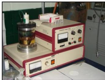
**Fig. 27 Recubridor Iónico (SPI – MODULE Sputter Coater).**
