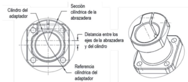
Figura 3. Detalle del diseño de la abrazadera en el adaptador superior (el adaptador de pie lleva el mismo diseño de abrazadera)
