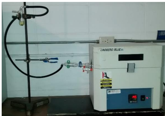
Figura 23. Sistema de reacción para la síntesis con temperatura en ausencia de solvente
