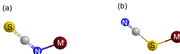
Figura 8. Ligando ambidentado (a) ligando isocianato, el cual coordina por el átomo de N (b) ligando tiocianato, el cual coordina por el átomo de S.
