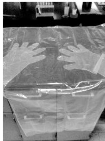
**Figura 30.** Materiales empleados en la síntesis mecanoquímica. (a) Mortero y mazo de cerámica. (b) Bolsa seca.
